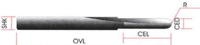
Цилиндрическая двухзаходная фреза без удаления стружки (Прямоугольная) со сферическим торцом - Диаметр сферического наконечника равен рабочему диаметру фрезы. Используется на всех этапах при обработке 3D объектов. Возможно использование для чистовой обработки древесины твердых пород.
